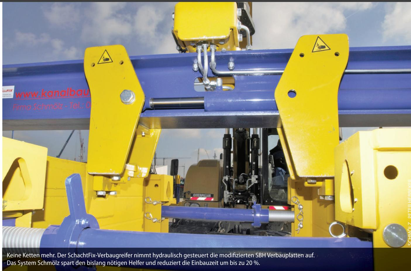
Keine Ketten mehr. Der SchachtFix-Verbaugreifer nimmt hydraulisch gesteuert die modifizierten SBH Verbauplatten auf. Das System Schmölz spart den bislang nötigen Helfer und reduziert die Einbauzeit um bis zu 20 %.
