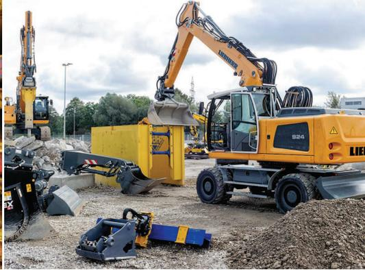
Dauerleihgabe: Liebherr nutzt in seinem neuen Entwicklungs- und Vorführcentrum in Kirchdorf eine Verbaubox vom Typ „Manhole System Schmölz“, um die Leistungsfähigkeit der Bagger zu demonstrieren. Im Vordergrund: der Schmölz SchachtFix-Verbaugreifer.
